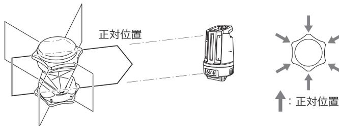
ATP2SII：プリズム上面の6本の印を直線に結ぶ線が、水平方向の正対位置です。
