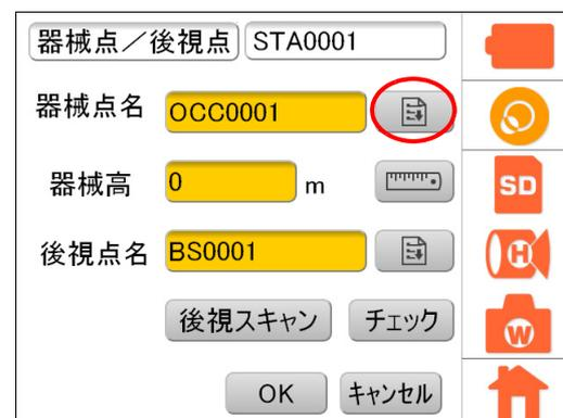
4. 座標点リストから、器械点に設定したい座標点を選択して【OK】を押します。
