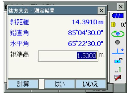
3点目以降に【自動】が表示されます。【自動】を押すと、本機が回転して3点目以降の点を自動観測します。
