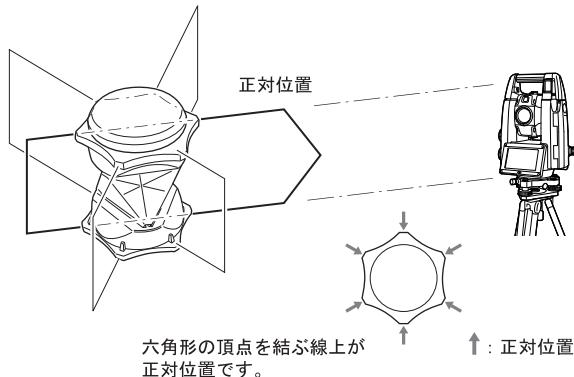
360° スライドプリズム (ATP1S II) の場合は、プリズム上面の 6 本の印を直線に結ぶ線上が、水平方向の正対位置です
