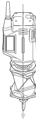
リモートコントローラーの中心とプリズムの正対位置が合わないときは調整をします。プロテクター RP3 をはずし、リモートコントローラー下面の調整ねじ①を六角レンチでゆるめて、位置合わせをして固定します。調整ねじ①だけで正対位置が合わない時は、360° プリズム ATP1 を取りはずして、内側の調整ねじ②で調節します。調整ねじ②の位置をどちらかの端までよせて固定し、調整ねじ①で位置合わせをします。それでも位置が合わないときは、調整ねじ②を反対側の端によせて固定すると、調整ねじ①で位置合わせができます。
