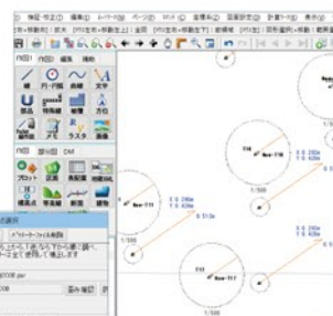
PatchJGD 座標補正 ベクトル図配置
