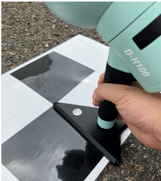
基準点（GCP）の取得（「十字部分」を基準点に合わせる）
