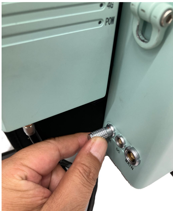
RTK ケーブルをコントロールボックスと GNSS モジュールの RTK インターフェースにそれぞれ挿入する
