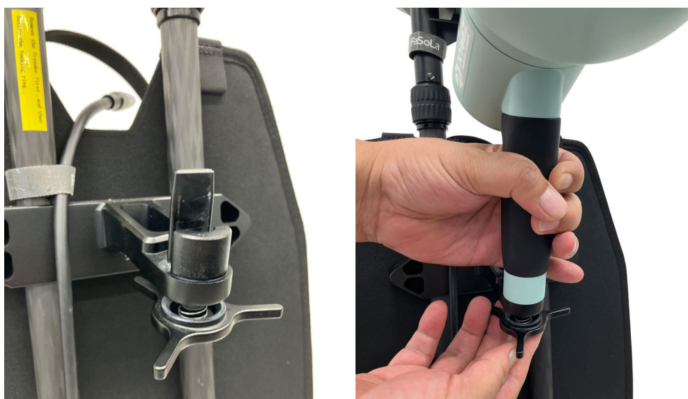
D-H100 本体をバックパックキットの上部に差し込んでネジで締める
