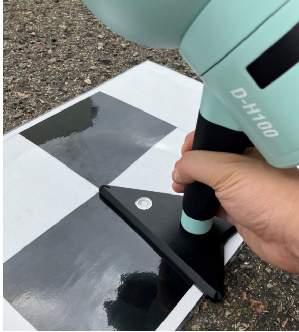
基準点（GCP）の取得（「十字部分」を基準点に合わせてる）
