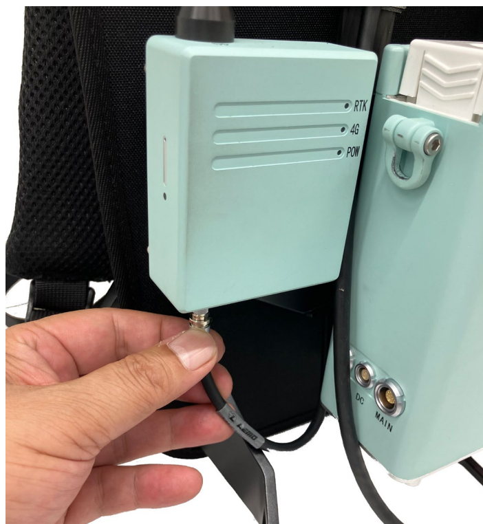
GNSS フィーダーケーブルを GNSS モジュールの GNSS インターフェースに挿入する
