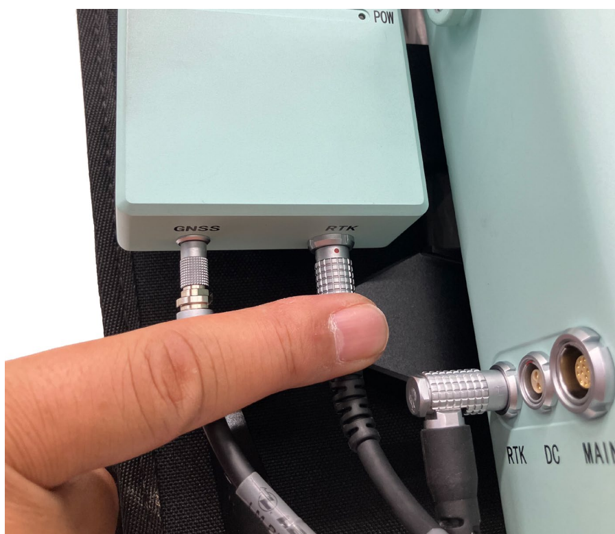
RTK ケーブルをコントロールボックスと GNSS モジュールの RTK インターフェースにそれぞれ挿入する
