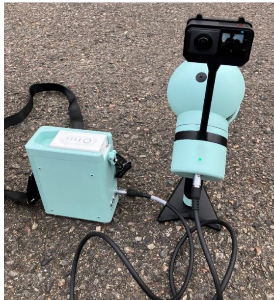
レーザーの回転が終わると自動的にカメラも録画を停止する
