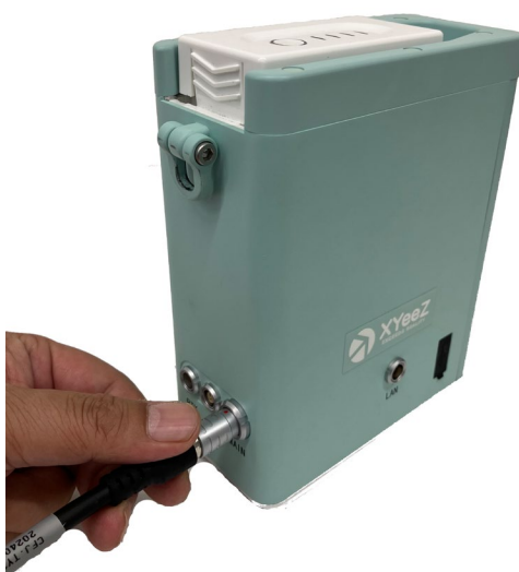
電源ケーブルをバッテリーボックス（メインポート）に接続
