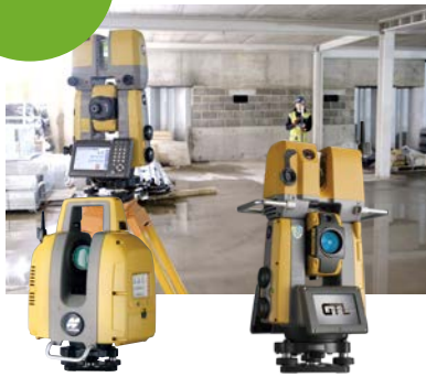
3Dレーザーキャナー レーザーキャナートラックステーション GLS-2000 GTL-1000 3D 計測製品でコンクリート打設面を 点群計測
