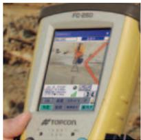
データコレクタ用アプリケーション「監督さん.V」との組み合わせで、画像による直観的な操作の、「測量が見える」イメージワンマン測量を実現します。
