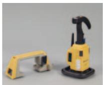
RCシステムを追加すれば、半径300mの範囲でワンマン測量が可能。方が一追尾をロストしても、RCシステムでスムーズに観測を続けることができます。
